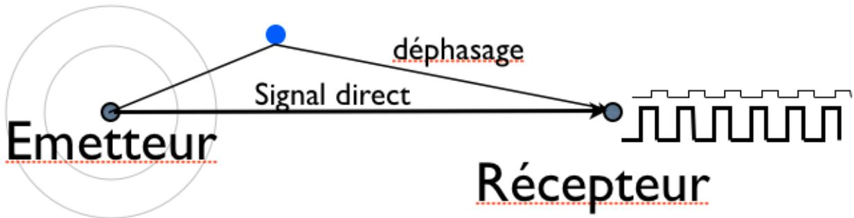
rapport à la fréquence d'un signal ultra-sonore. Une émission sonore calibrée va être reçue en direct et suite aux réflexions sur les gouttes qui tombent entre l'émetteur et le récepteur. Le «brouillage» du signal reçu dépend statistiquement de l'intensité de la pluie.
